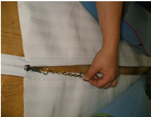
Foto 3: avvicinare le due testate della tela dopo essersi assicurati che il senso della direzione di marcia sia esatto.
